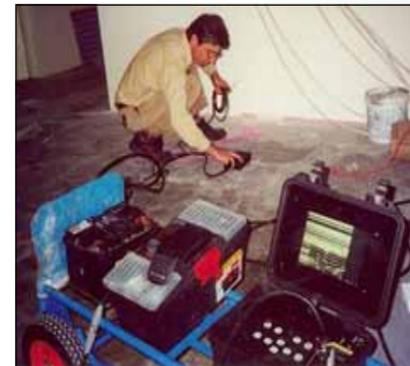
USING 1.2GHz ANTENNA FOR TENDON DUCT LOCATION
